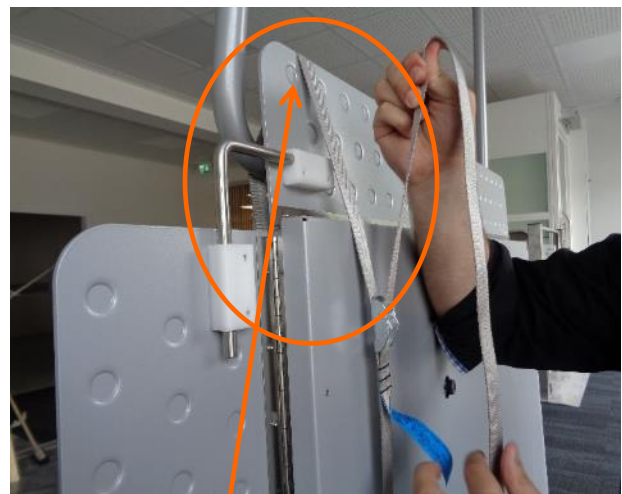
Pokud je nainstalována přední nájezdová rampa , protáhněte napínací pás přes horní okraj rampy.
