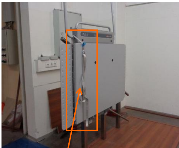
Při utahování napínacího pásu věnujte zvýšenou pozornost. Pás nesmí poškrábat povrch jednotky!
